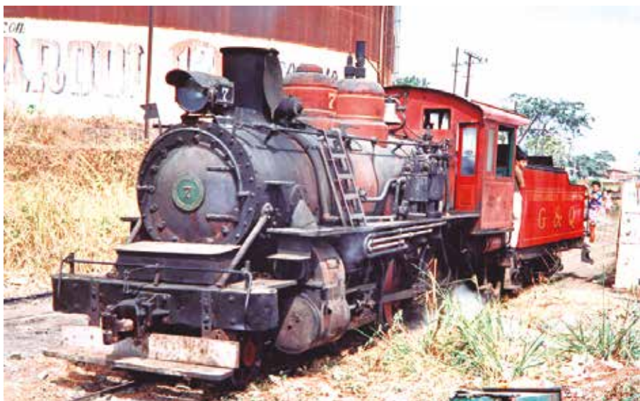
Apreciamos atrás de la locomotora 7 el tanque de almacenamiento de petróleo para aprovisionar a las locomotoras de vapor.
